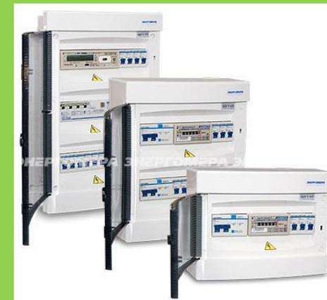
Под щит выбирается доступное место. Обычно его устанавливают в прихожей, вблизи от ввода кабеля питания. Высота установки составляет 1,5-1,7 м. В специальный бокс щита со смотровым окошком помещается счетчик. В стене делаются отверстия, чтобы закрепить короб на дюбели или саморезы.
