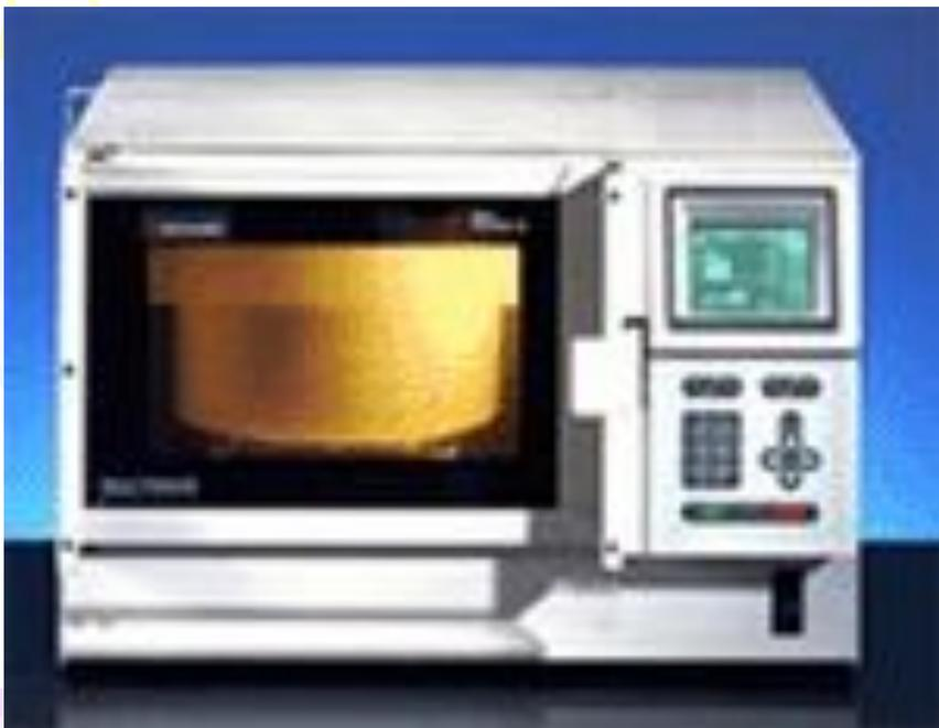
Высокочастотное излучение (микроволновое поле) ускоряет извлечение загрязнителей из матрицы. По эффективности МВ-нагрев в комбинации с ЖЭ не уступает СФЭ.
