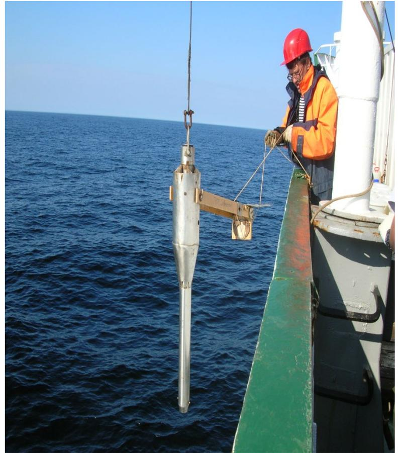
Трубка ударного типа
