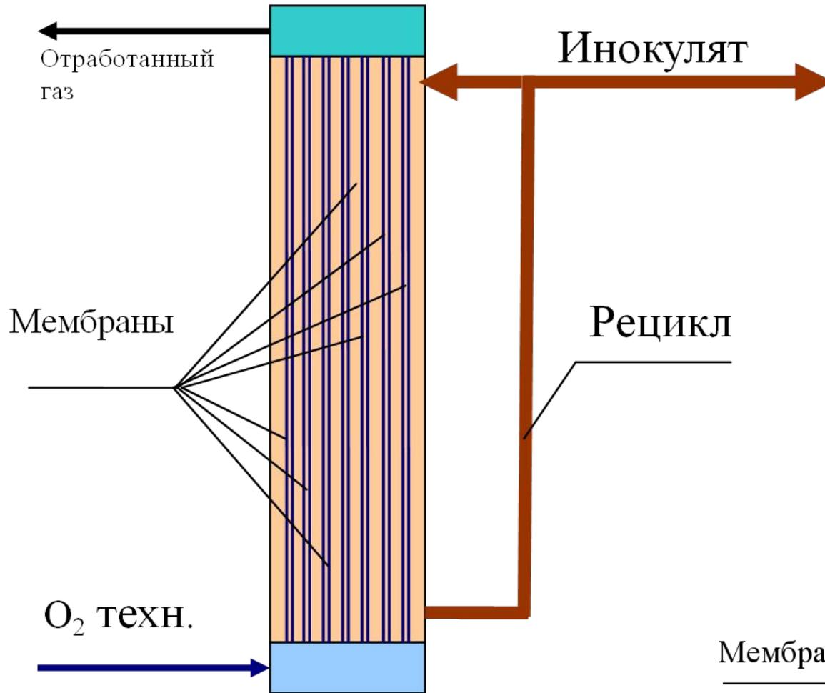
Схема потоков газа и КЖ
