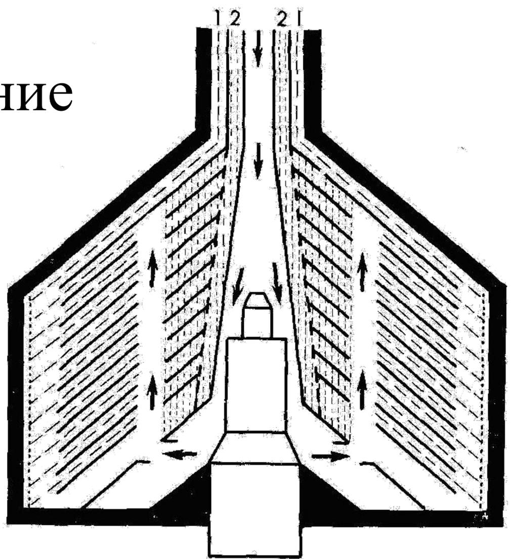
Схема барабана сепаратора для очистки и сепарирования молока: 1 - обезжиренное молоко; 2 - сливки
