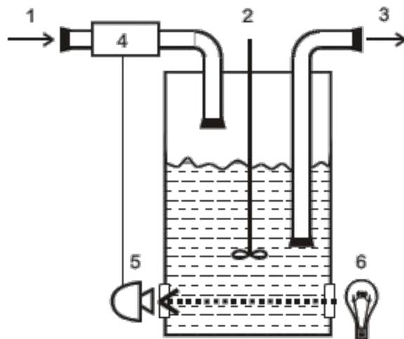
Турбидостат с автоматической регуляцией оптической плотности: 1 - поступление среды; 2 - мешалка; 3 - сток культуры; 4 - насос; 5 - фотозлемент; 6 - источник света
