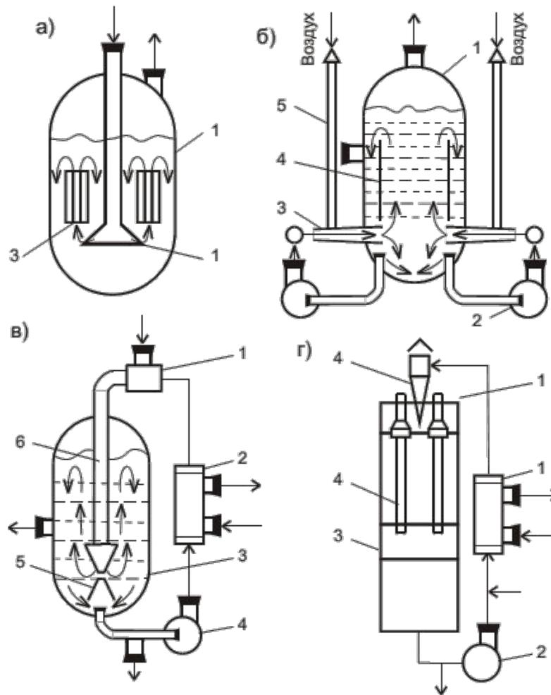
Ферментеры группы ФЖ: а) с самовсасывающей мешалкой: 1 - корпус, 2 - мешалка, 3 - циркуляционный контур-теплообменник; б) эжекционный: 1 - корпус, 2 - насос, 3 - эжектор; в) струйный с затопленной струей: 1 - эжектор, 2 - теплообменник, 3 - корпус, 4 - насос, 5 - рассекаТЕЛЬ, 6 - труба с насадкой; г) струйный с падающей струей: 1 - теплообменник, 2 - насос, 3 - корпус, 4 - эжектор
