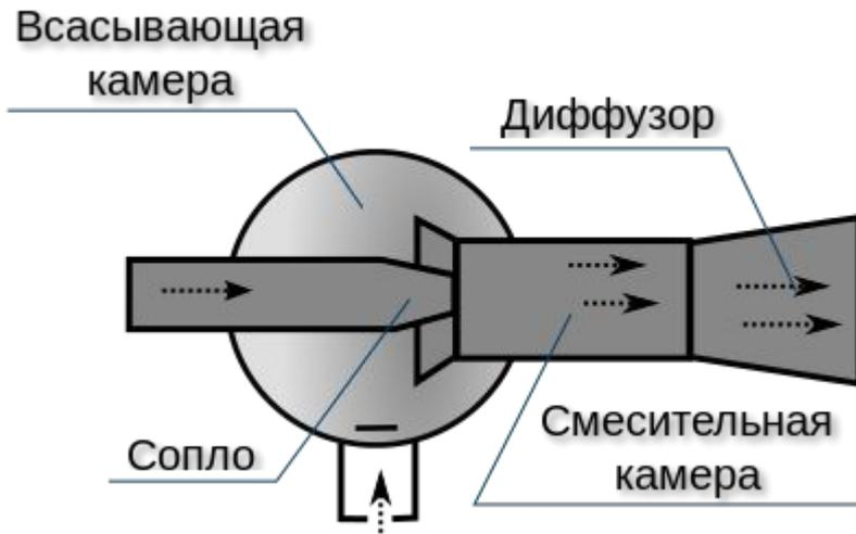
**Эжектор** - устройство, в котором происходит передача кинетической энергии от одной среды, движущейся с большей скоростью, к другой. Эжектор, работая по закону Бернулли, создаёт в сужающемся сечении пониженное давление одной среды, что вызывает подсос в поток другой среды, которая затем переносится и удаляется от места всасывания энергией первой среды. Эжекторы используются в струйных насосах, например водоструйных, жидкостно-ртутных, паро-ртутных, паромасляных.
