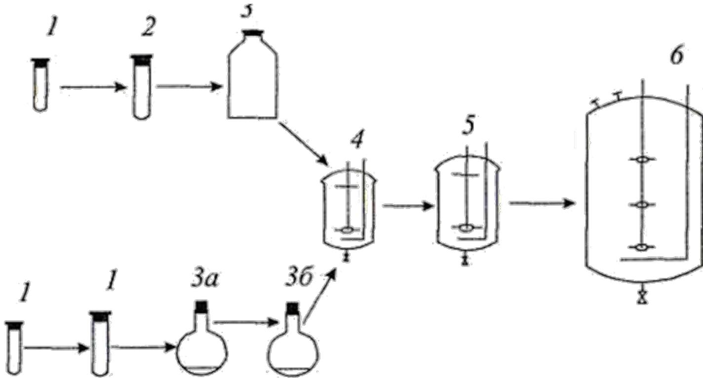
Схема приготовления посевного материала: 1 - законсервированный штамм; 2 - выращивание на скошенном агаре; 3а, 3б - выращивание на плотной питательной среде; 4 - инокулятор; 5 - участок чистой культуры; 6 - промышленный биореактор
