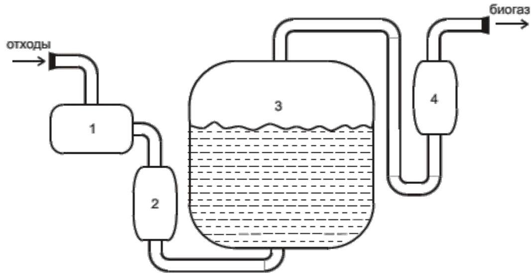
Схема метановой установки: 1 - дозирующее устройство; 2 - теплообменник; 3 - метанотенк; 4 - газгольдер
