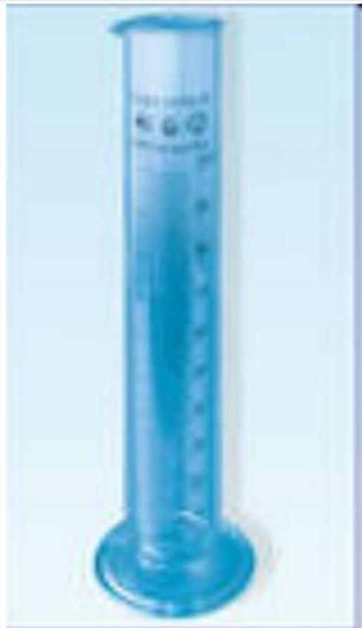
Мерный цилиндр используется для измерения большого объема жидкостей
