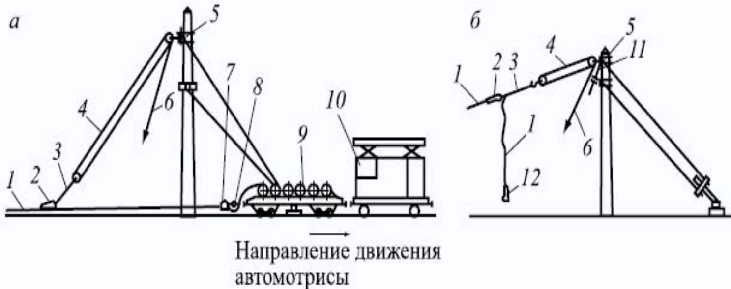
Рис. Схема натяжения несущего троса (а) и выполнения его постоянной анкеровки (б) с помощью автотрисы и полиспаста
