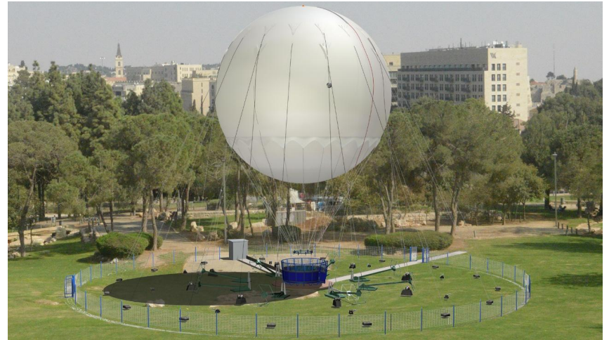
Верхняя швартовка при ветре до 15 м/сек
