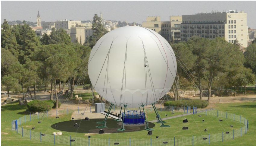
Нижняя швартовка для штормового ветра
