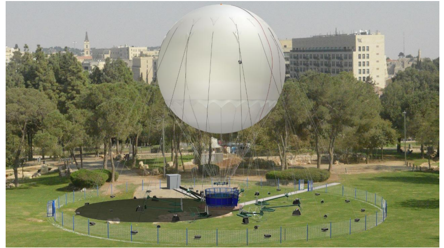
Верхняя швартовка при ветре до 15 м/сек
