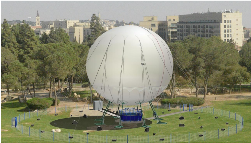
Нижняя швартовка для штормового ветра
