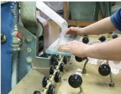
Шлифовка и полировка торца
