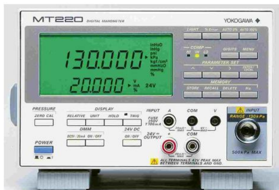
Цифровой манометр MT220 фирмы Yokogawa (-80...3000 кПа)
