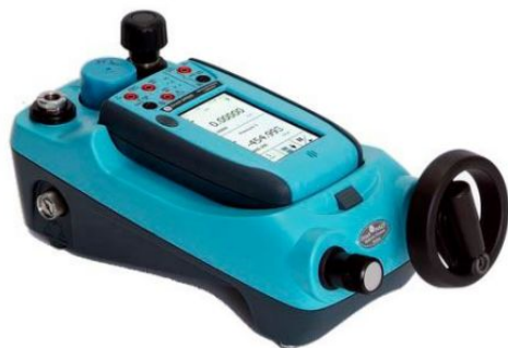
DPI 620 - многофункциональный модульный калибратор давления
