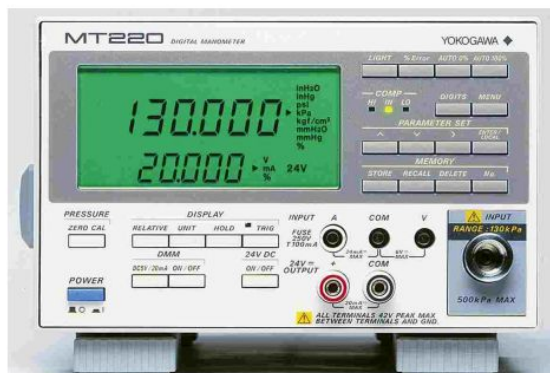
Цифровой манометр MT220 фирмы Yokogawa (-80...3000 кПа)
