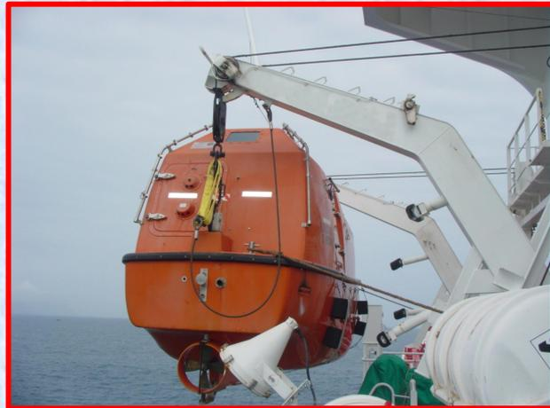
Спуск обслуживаемых спусковым устройством коллективного спасательного средства либо дежурной шлюпки с полной нагрузкой и снабжением, а также порожнем не должен обеспечиваться какими-либо способами, иными чем с помощью силы тяжести или накопленной механической энергии, не зависящей от судовых источников энергии.
