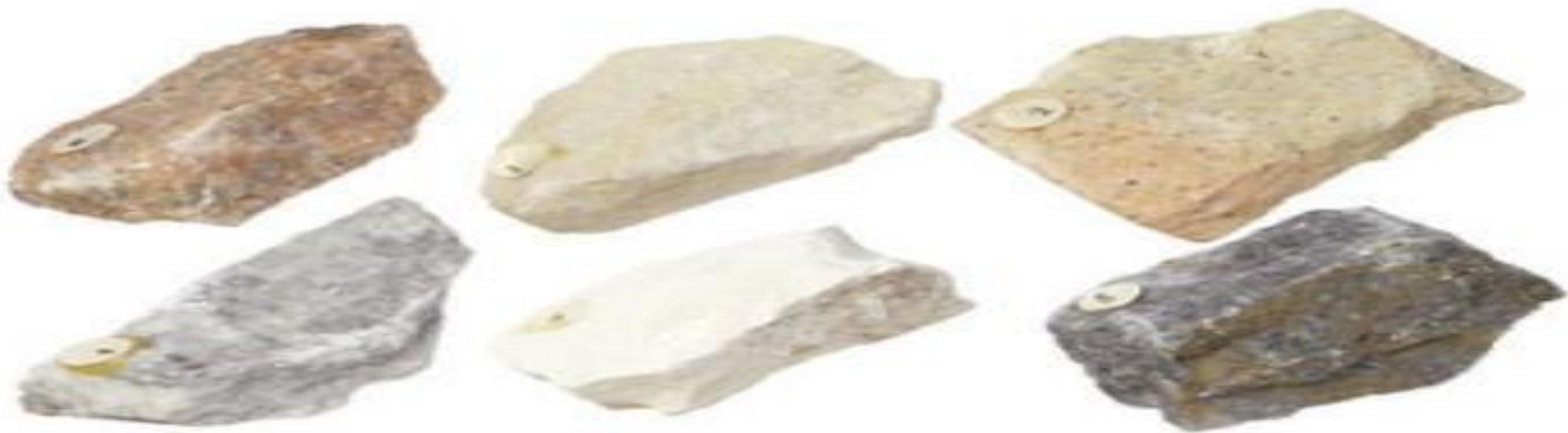
**Известняк часто встречается в природе. Из него могут быть сложены целые горы, или он может залегать глубоко в земле мощными толстыми слоями. С давних пор люди получали из известняка известь, известковые растворы, строительные камни. Дома и стены часто делали из этого камня. Существует выражение «Москва белокаменная». Многие здания в старой Москве были построены из известняка.**
