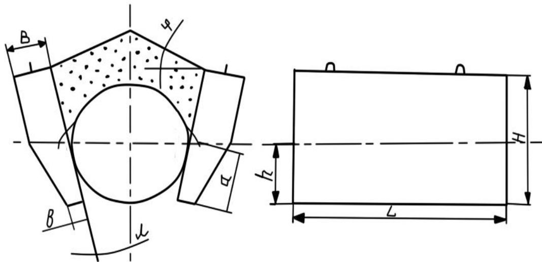
Схема железобетонного утяжелителя типа 2-УТК и
