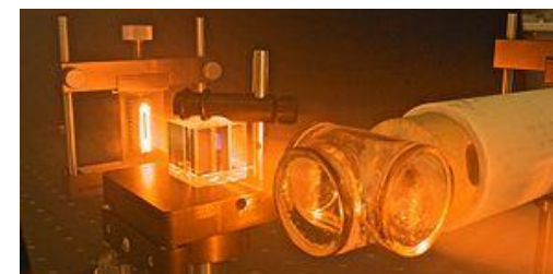
SERF-магнитометр (свободный от спин-обменного уширения)
