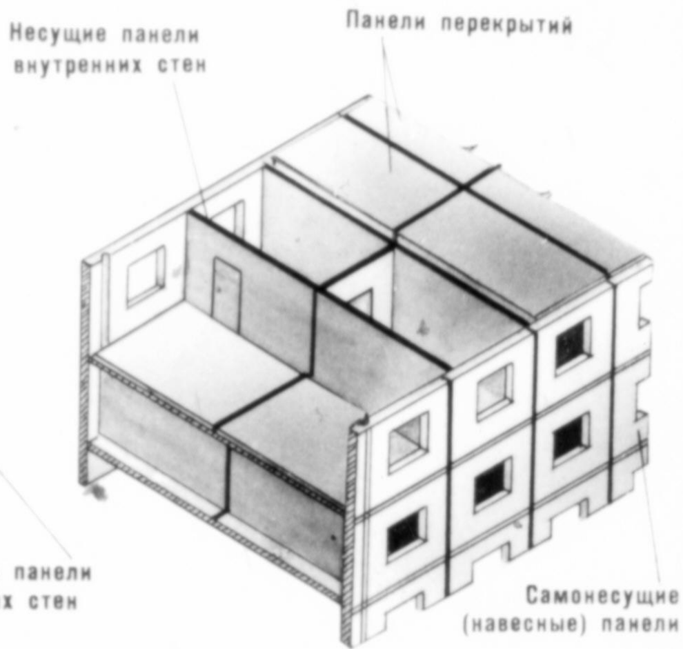
с поперечными несущими стенами
