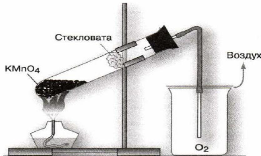
Прибор для получения и сбивания кислорода методом вытеснения воздуха
