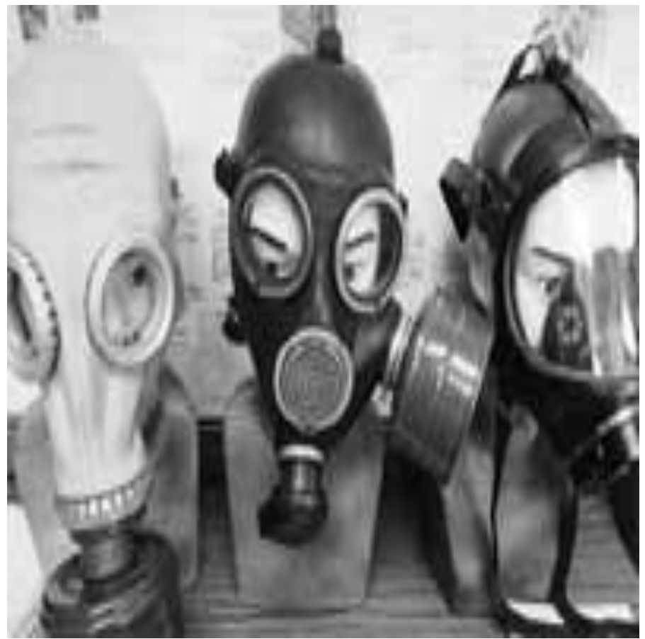
Н.Д.Зелинский на основе адсорбционных свойств древесного угля разработал фильтрующий противогаз
