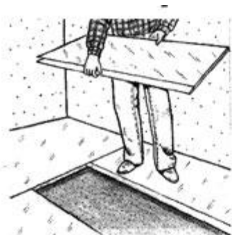
13 Плотная стыковка готовых элементов
