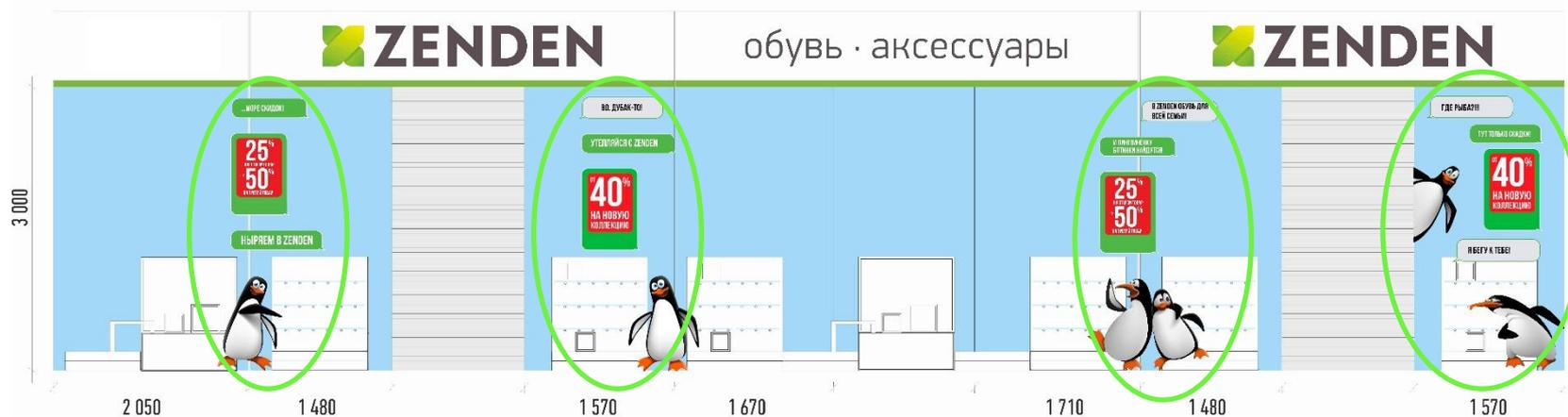
**Техническое задание:** Основа пенокартон 3мм + прямая интерьерная печать 720dpi или накатка самоклеющейся пленки с печатью 720dpi с 2-х сторон. Монтаж на леску и силиконовые капли в витрину согласно компоновки композиции.
