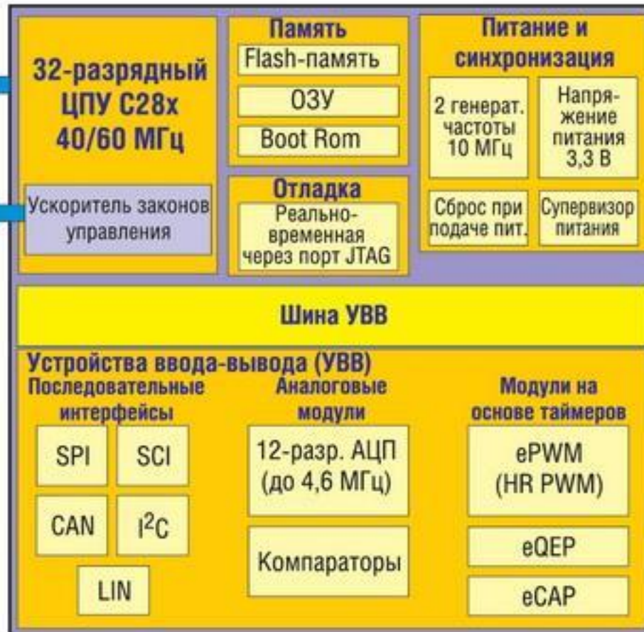
Обобщенная структура микроконтроллеров Piccolo
