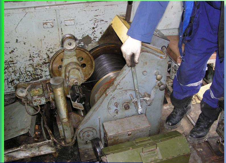
Если при спуске прибор начинает идти вниз рывками, то скорость спуска уменьшают торможением до прекращения рывков. В месте перехода колонны НКТ с одного диаметра на другой скорость спуска должна быть так же снижена.
