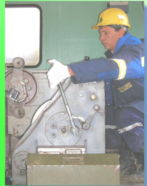
При необходимости допускается вымотка остатков проволоки с барабана лебедки. При этом на проволоку над сальниковой головкой лубрикатора устанавливается предохранительный зажим. В этом случае, перед началом подъема после намотки проволоки на барабан, получившееся показание счетчика сверяют с фактической глубиной спуска .
