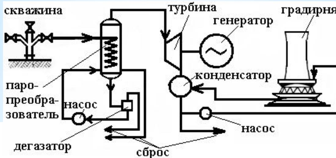
*Схема ГеоТЭС с паропреобразователем*
