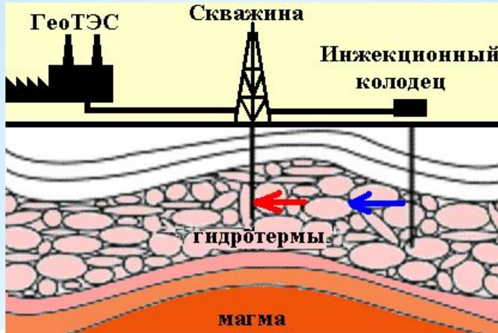
Новое направление – циркуляционные геотермальные системы с закачкой холодной воды в термоводоносный проницаемый горизонт с дальнейшим извлечением разогретой. Может применяться на малой глубине (~100-200 м).
