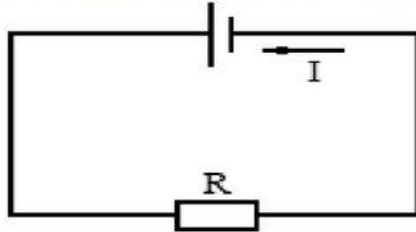
Рассмотрим простейшую полную (замкнутую) цепь, состоящую из источника тока и резистора сопротивлением  $R$ .
