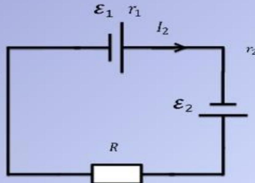
На рисунке указана цепь, ток в которой равен 2 А. Известно, что при коротком замыкании, ток становится равным 82 А. Внешнее сопротивление равно 20 Ом. Тогда какой источник нужно включить в эту цепь, чтобы увеличить в ней силу тока до 4 А и полную ЭДС до 90 В?
