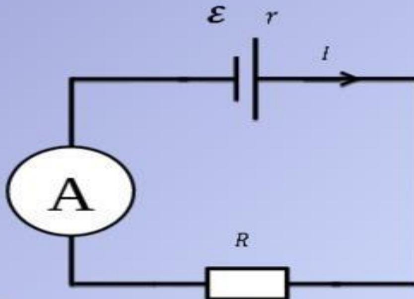
На рисунке указана цепь, ток в которой равен  $2 \text{ А}$ . Известно, что при коротком замыкании, ток становится равным  $82 \text{ А}$ . Внешнее сопротивление равно  $20 \text{ Ом}$ . Тогда какой источник нужно включить в эту цепь, чтобы увеличить в ней силу тока до  $4 \text{ А}$  и полную ЭДС до  $90 \text{ В}$ ?
