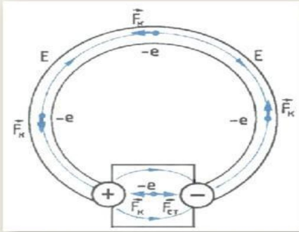
При замыкании цепи создаётся электрическое поле во всех проводниках цепи.
