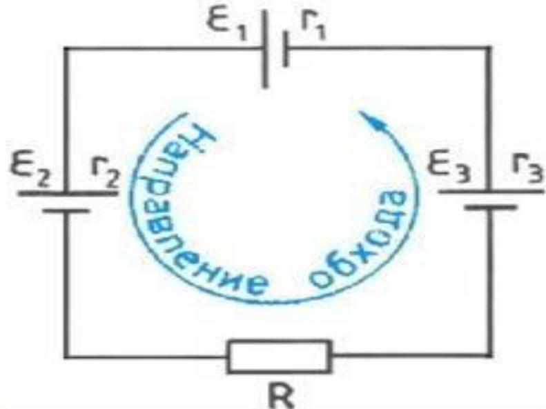
Если цепь содержит несколько последовательно соединённых элементов с ЭДС  $\varepsilon_1, \varepsilon_2, \varepsilon_3$  и т.д., то полная ЭДС цепи равна алгебраической сумме ЭДС отдельных элементов.
