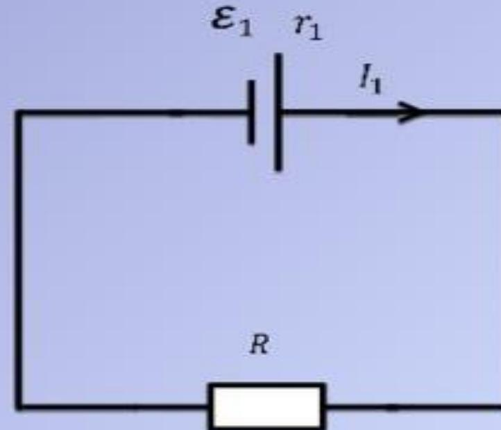
На рисунке указана цепь, ток в которой равен 2 А. Известно, что при коротком замыкании, ток становится равным 82 А. Внешнее сопротивление равно 20 Ом. Тогда какой источник нужно включить в эту цепь, чтобы увеличить в ней силу тока до 4 А и полную ЭДС до 90 В?
