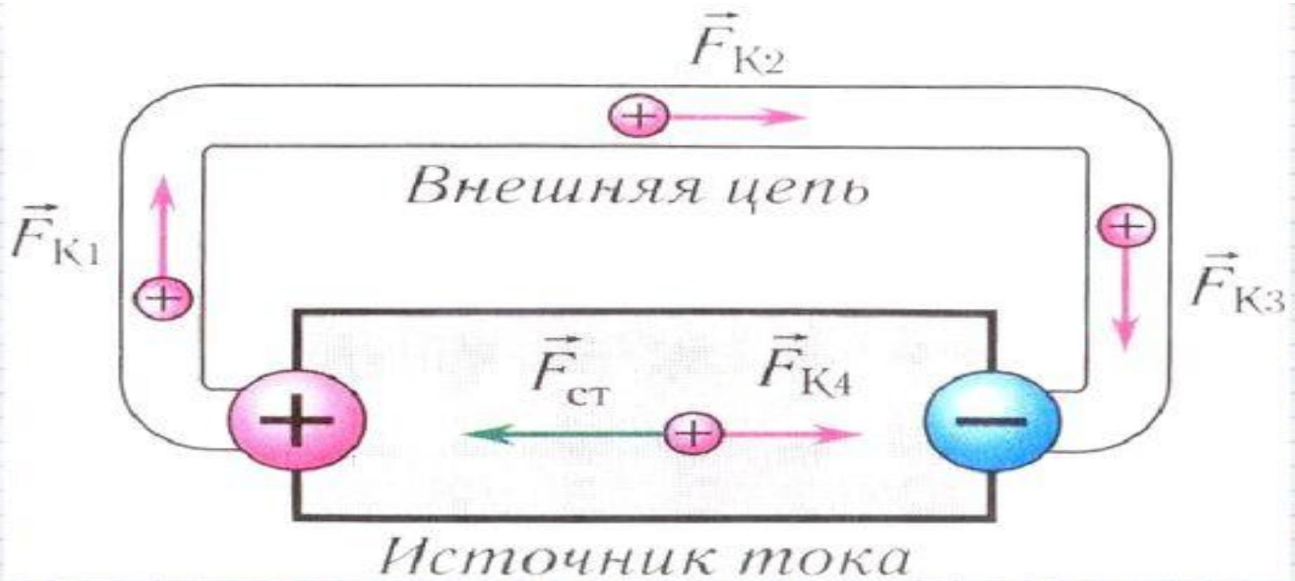
**Внутри источника тока заряды движутся под действием сторонних сил против кулоновских сил (электроны от положительного заряженного электрода к отрицательному), а во всей остальной цепи их приводит в движение электрическое поле.**
