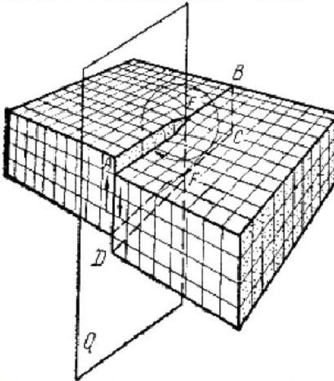
Рис. 7. Механизм образования винтовой дислокации
