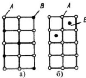
Рис.13. Кристаллическая решетка твердых растворов замещения (а), внедрения (б)
