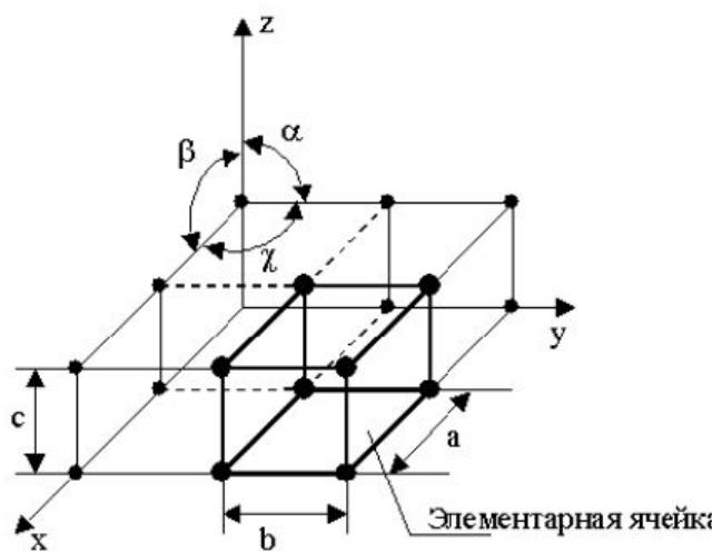
Рис. 1. Схема кристаллической решетки
