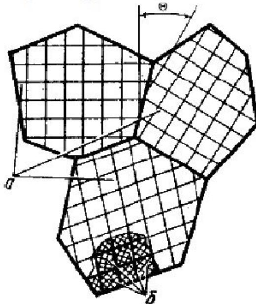
Рис. 9. Разориентация зерен и блоков в металле
