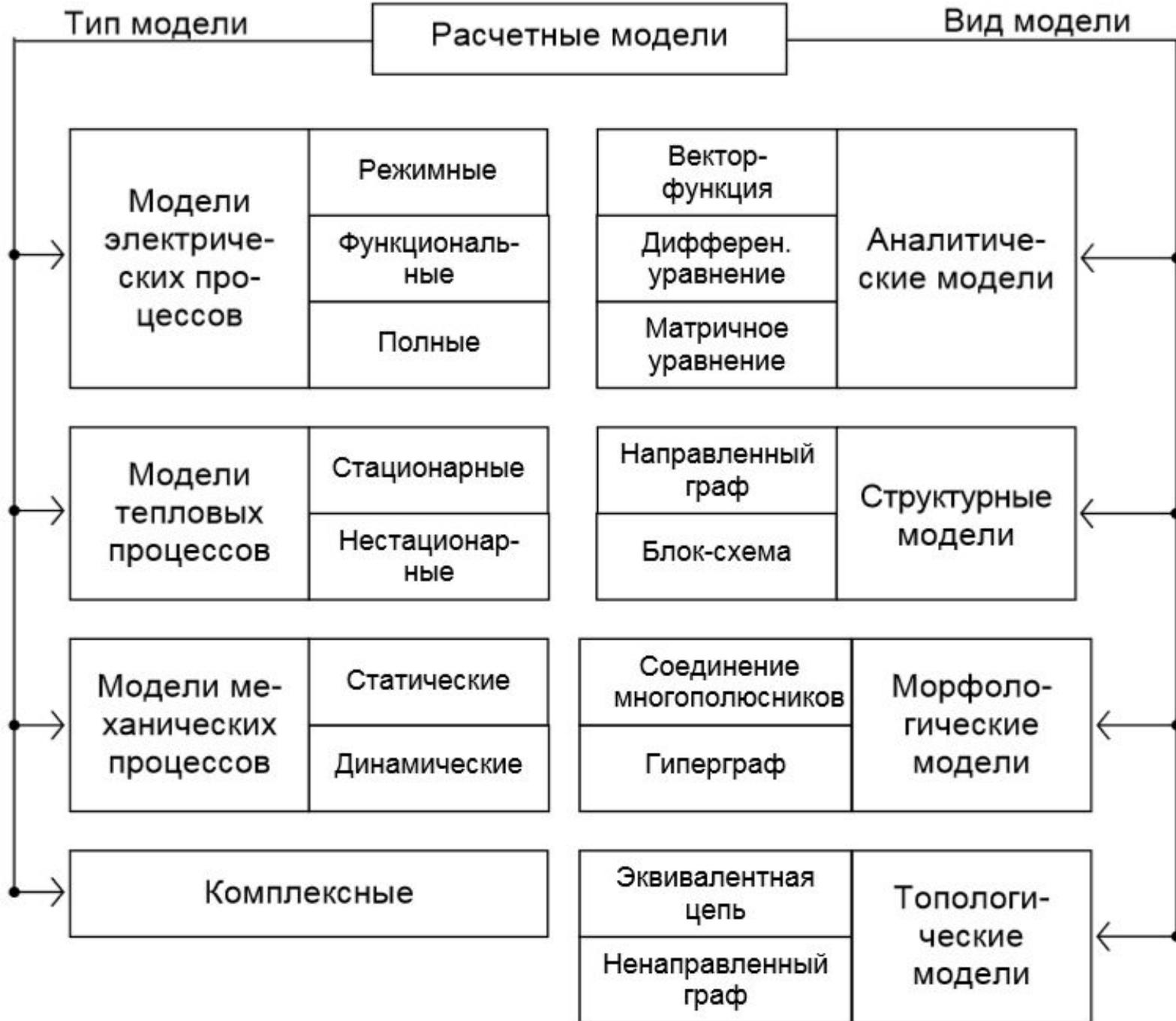
Под **аналитической расчетной моделью** понимается математическая модель, представленная средствами математического анализа и алгебры в форме буквенных выражений, определяющих зависимость выходных характеристик ПС и его показателей от входных воздействий, внутренних параметров и независимых аргументов (времени, частоты, пространственных координат, переменной преобразования Лапласа и пр.).
