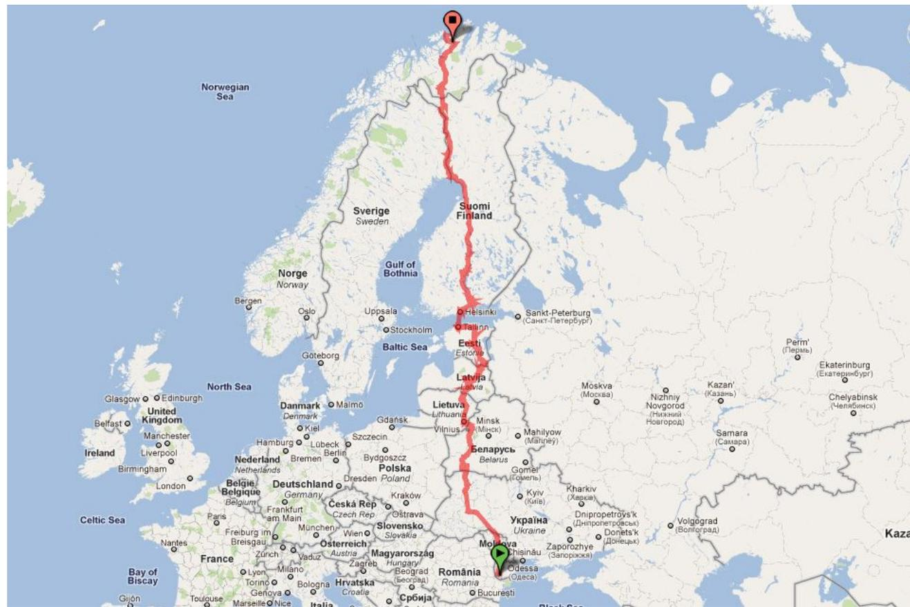
**Дуга Струве** - сеть из 265 триангуляционных пунктов, представлявших собой заложенные в землю каменные кубы с длиной ребра 2 метра, протяжённостью более 2820 километров. Создавалась с целью определения параметров Земли, её формы и размера. Названа по имени создателя — российского астронома Фридриха Георга Вильгельма Струве (Василия Яковлевича Струве).
