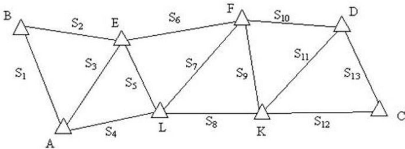
(от [лат.](#) *trilaterus* — трёхсторонний) — метод определения [геодезических](#) пунктов путём построения на местности системы смежных треугольников, в которых измеряются длины их сторон
