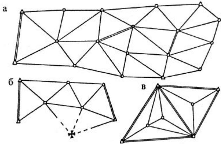
Заключается в геодезическом построении на местности системы пунктов, образующих треугольники, у которых измеряются все углы и длины некоторых базовых (базисных) сторон. Схема построения триангуляции зависит от геометрии объекта, технико-экономических условий, наличия парка приборов и квалификации исполнителей.
