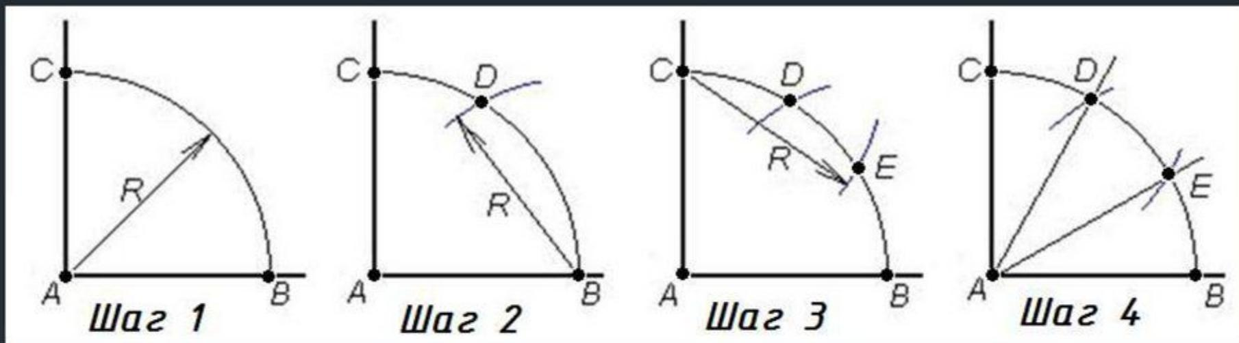
1. Из вершины прямого угла A, как из центра, провести дугу BC произвольного радиуса R.
