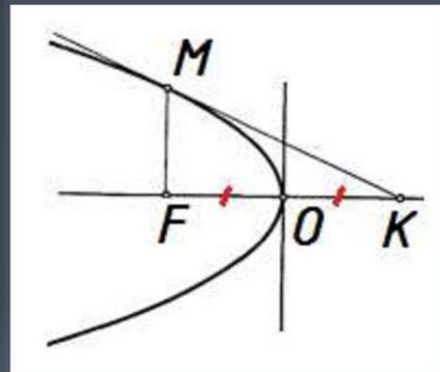
Расстояние  $KF$  между директрисой и фокусом называется параметром  $p$  параболы. Точка  $O$ , лежащая на оси симметрии, называется вершиной параболы и делит параметр  $p$  пополам.
