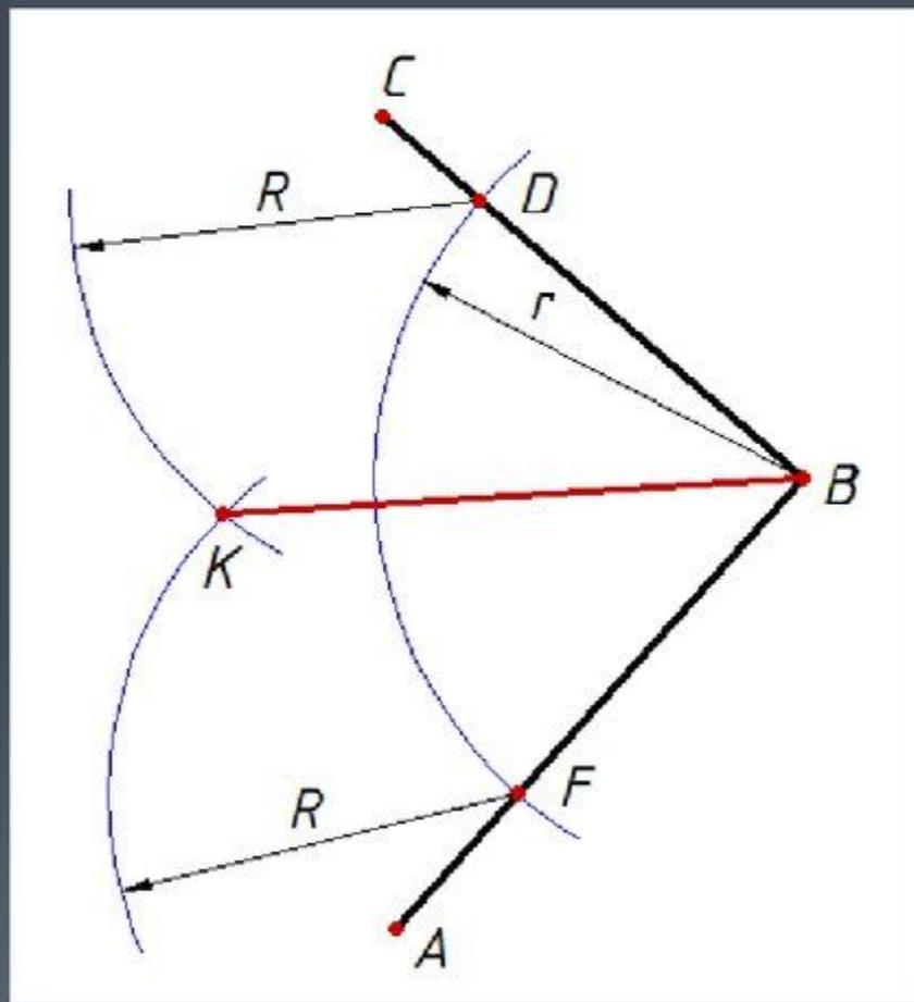
1. Из вершины угла  $B$  построить дугу любого радиуса  $r$ , которая отсечет на сторонах угла отрезки одинаковой длины  $BD$  и  $BF$ .
