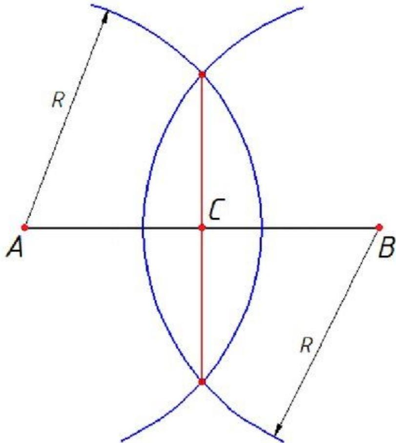
1. Из конечных точек отрезка  $AB$  построить дуги одинаковых радиусов произвольной величины, но больших половины отрезка, до их взаимного пересечения.
