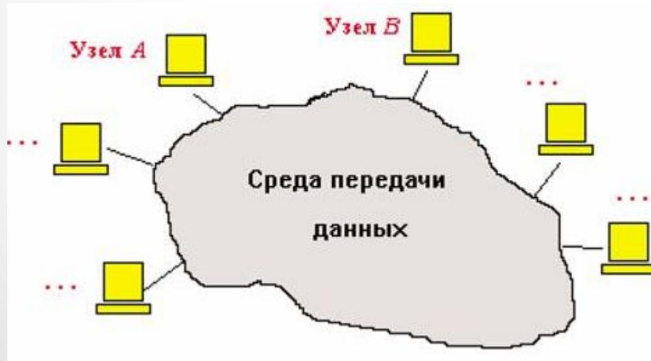
Передатчик служит для преобразования полученного от абонента сообщения в сигнал, передаваемый по каналу связи, приемник – для обратного преобразования сигнала в сообщение, поступающее абоненту.
