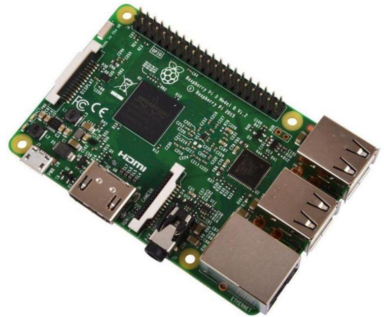
Raspberry Pi — это одноплатный компьютер, построенный на ARM-архитектуре обладающий небольшой ценой и скромными габаритами. У него есть процессор, ОЗУ, видеоускоритель, а некоторые вариации обладают множеством полноценных разъёмов, включая USB, Ethernet и microHDMI. Иными словами, он полностью готов к работе из коробки. Микрокомпьютер разрабатывается британской компанией Raspberry Pi Foundation. Изначально разработанный для обучения, Raspberry Pi обрёл широкое распространение среди энтузиастов.
