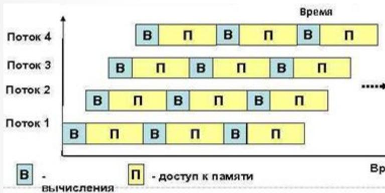
Идея распараллеливания вычислений основана на том, что большинство задач может быть разделено на набор меньших задач, которые могут быть решены одновременно. Обычно параллельные вычисления требуют координации действий.
