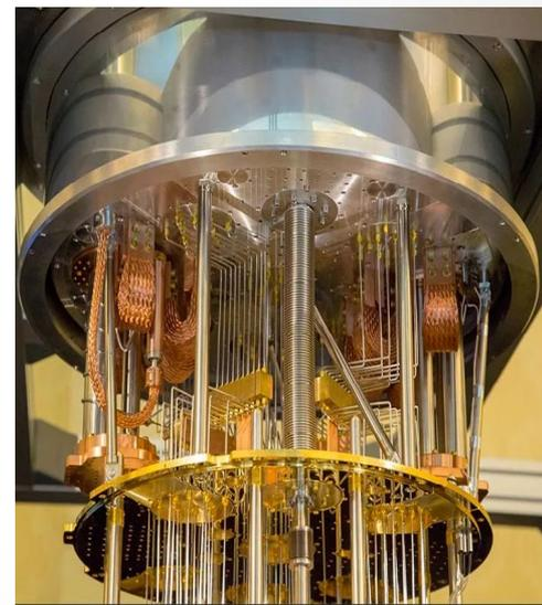
Примером многопроцессорных ВС — суперкомпьютеры, квантовые компьютеры
