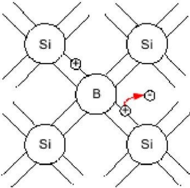
При введении трёхвалентной примеси три её валентных электрона восстанавливают ковалентную связь с атомами полупроводника, а четвёртая ковалентная связь оказывается не восстановленной, т. е. имеет место дырка. В результате этого концентрация дырок будет больше концентрации электронов.
