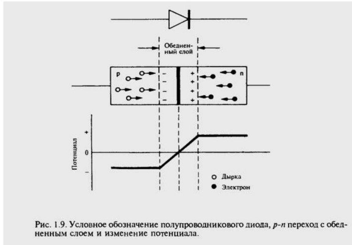
Рис. 1.9. Условное обозначение полупроводникового диода,  $p$ - $n$  переход с обедненным слоем и изменение потенциала.
