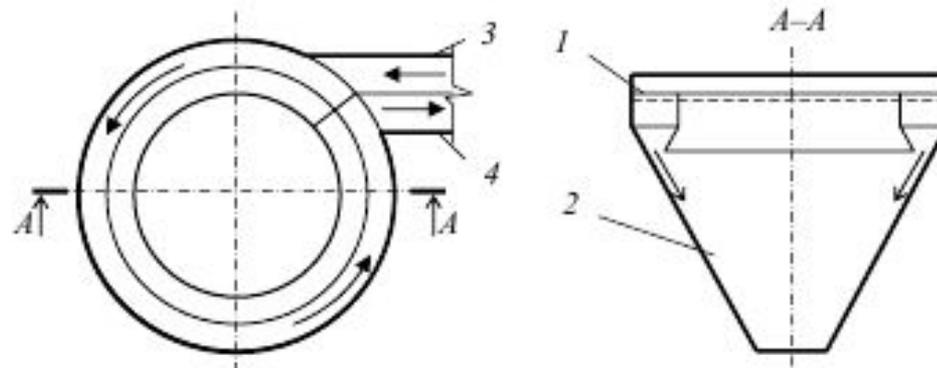
**Рис. 2. Горизонтальная песколовка с круговым движением воды**
