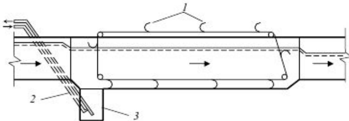
**Рис. 1. Горизонтальная песколовка**
