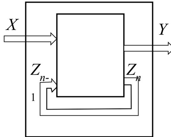
В цифровых схемах с памятью выходной сигнал зависит как от входного, так и от состояния триггеров. Связь между ними устанавливается функцией переходов  $\varphi(z, x)$ ; функцией выходов  $\psi(z, x)$ :
