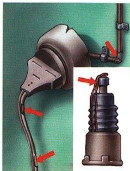
Неисправность электропроводки Пользование самодельными предохранителями
