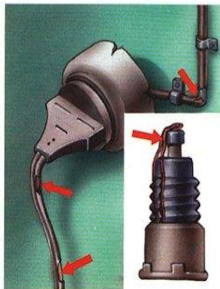
Неисправность электропроводки Пользование самодельными предохранителями
