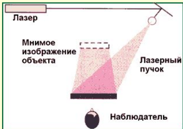
Схема восстановления изображения, записанного на пропускающей голограмме.
