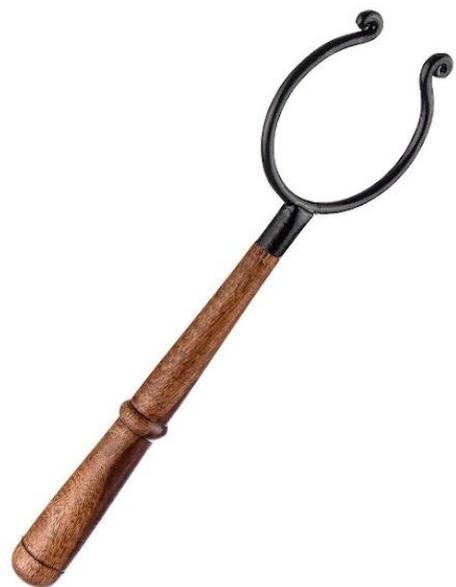
**Ухват, рогач** — ручной инструмент для перемещения глиняных и чугунных горшков для еды, установки их в топку русской печи. Представляет собой металлическую рогатку, закреплённую на длинном черенке. Под каждый размер чугунка был свой ухват.
