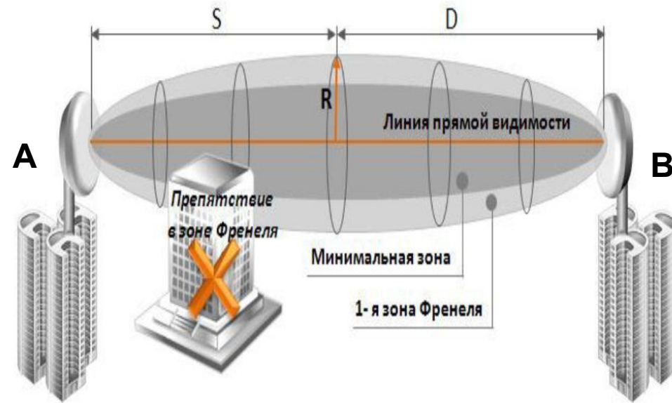
Рис. 3.3 – Зона Френеля между двумя домами
