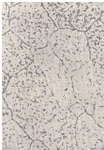
сплав Al-Cu (4 % Cu), x1000
