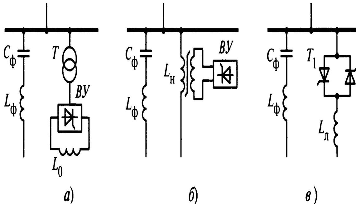
Принципиальные схемы статических компенсирующих устройств. Содержат фильтры высших гармоник (генерирующая часть)  $L_\phi C_\phi$  и регулируемый реактор в различных исполнениях.
