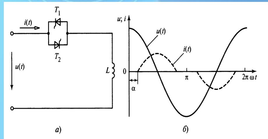
Схема фазоуправляемого тиристорного регулятора (а), кривые  $i(t)$ ,  $u(t)$  при угле управления  $\alpha \neq 0$  (б)
