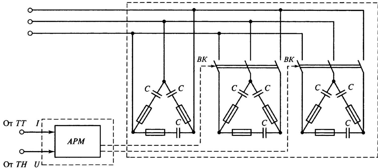
Принципиальная **схема регулируемой конденсаторной установки мощностью 112,5 квар**: С — конденсатор; ВК — вакуумный контактор; АРМ — блок автоматического управления; ТТ - трансформатор тока; ТН — трансформатор напряжения
