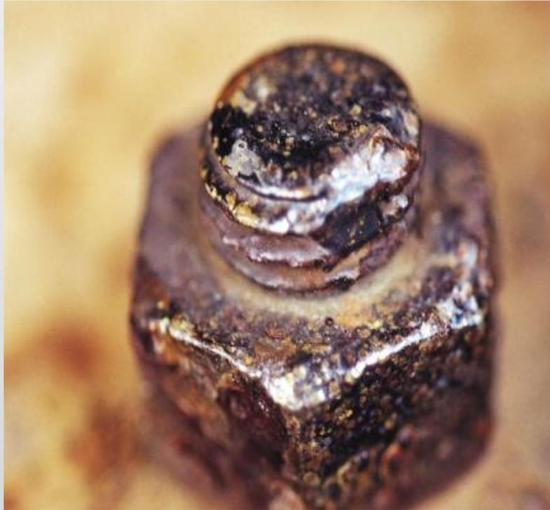
**Электрохимическая коррозия – это все случаи коррозии в присутствии воды и жидкостей – электролитов.**
