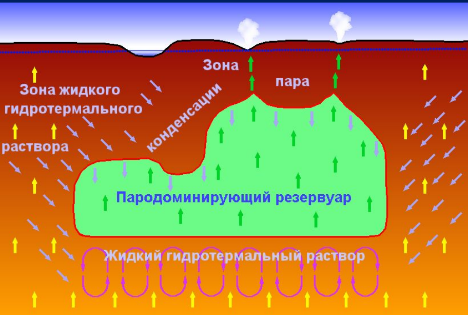
Схематический разрез через пародоминирующую зону Нижне-Кошелевского геотермального месторождения (по М.В.Писаревой, 1987).
