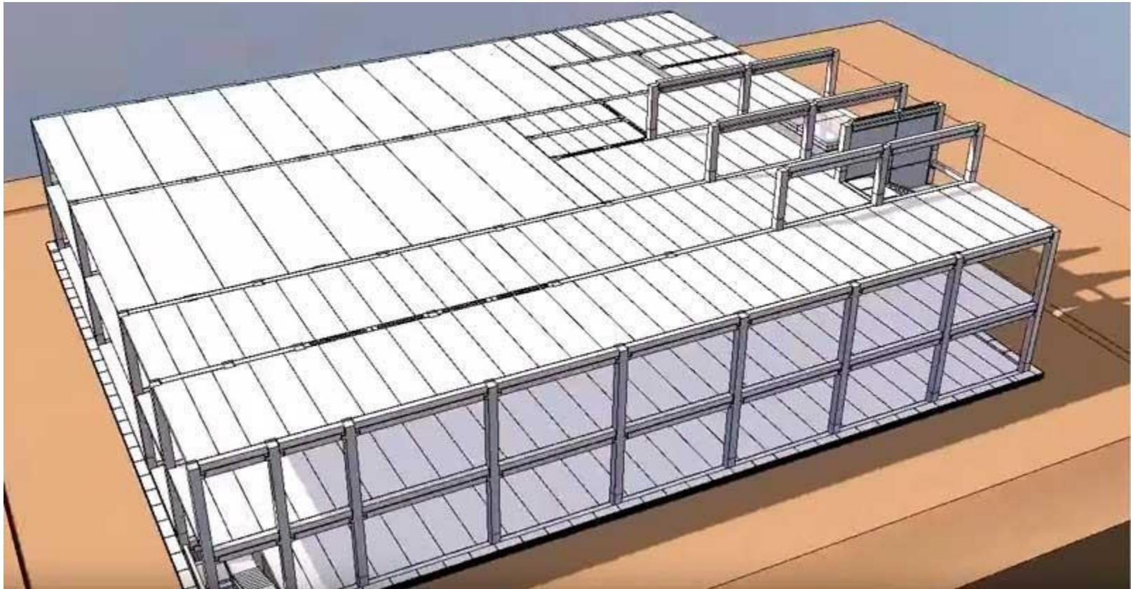
При строительстве промзданий учитывают технологию будущего производства, т.е. требуемую оснащенность зданий станками, поточными линиями, грузоподъемными кранами и другим оборудованием. В зависимости от этого определяют основные габаритные размеры внутреннего объема помещений (длину, ширину, высоту).
