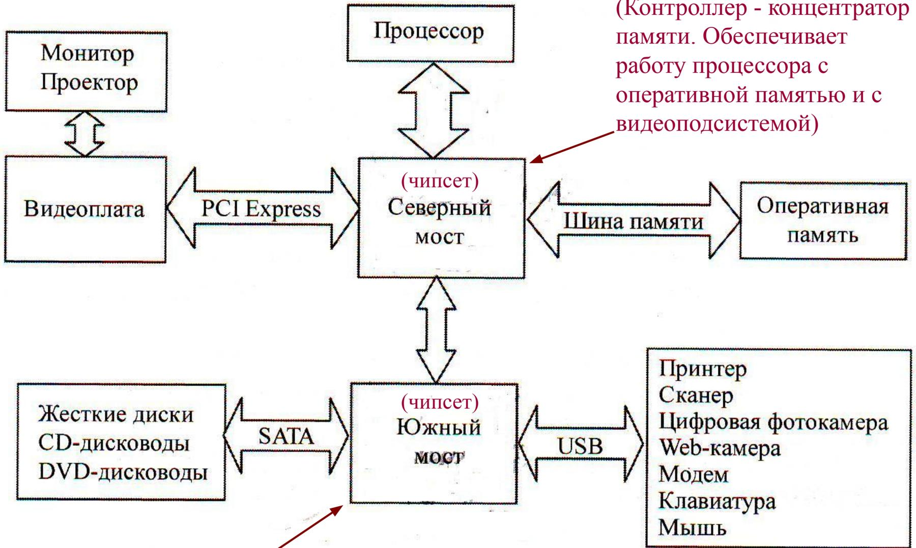
(Контроллер - концентратор памяти. Обеспечивает работу процессора с оперативной памятью и с видеоподсистемой)
