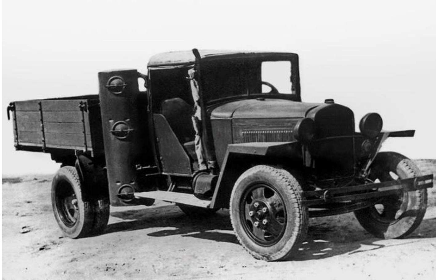
Инженеры Горьковского завода пошли предельно простым путем: с полупропуска сняли всё лишнее. Не стало ни металлических, ни фанерных дверей, их заменили брезентовые накладки. Крышу заменил тент с небольшим окошком сзади. Крылья гнули из простого кровельного железа, а от одного дворника, одной фары и передних тормозов пришлось отказаться. Полупропуск стала надежной рабочей лошадкой советских военных водителей. Простая и неприхотливая она ходила почти всегда с порожнем (иногда и с двойным)
