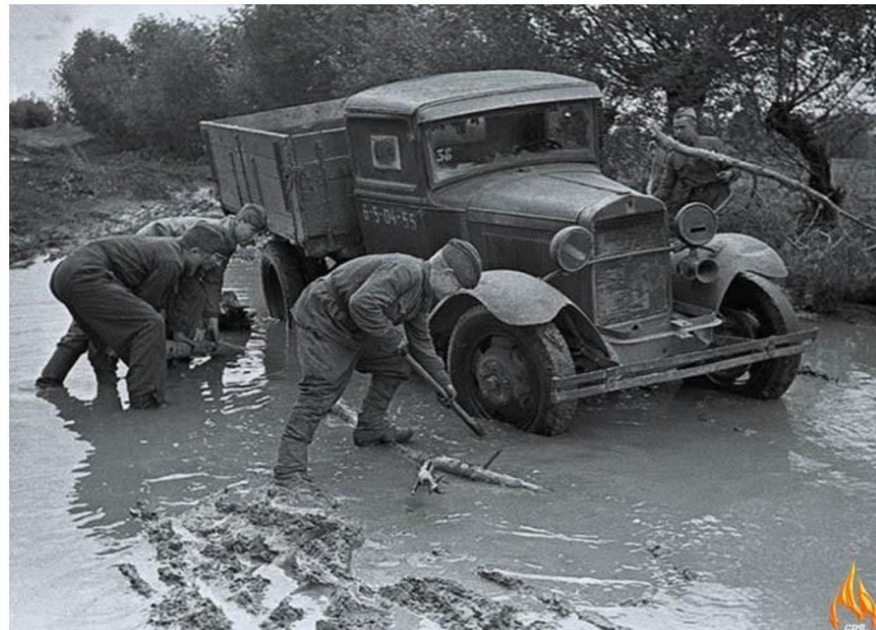
ГАЗ-АА был незаменим на войне, потому что имел несложную конструкцию, был очень надежен и чрезвычайно прост в эксплуатации. Полуторка прекрасно преодолевала бездорожье и разгонялась до 70 км/час по шоссе; на 100 км пути расходовала 20 литров низкооктанового бензина.
