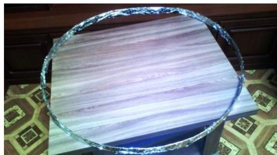
Следующее действие. Устанавливаем кольцо на пол. Чтобы получить во всех направлениях диаметр 78 см., делаем рулеткой измерения в разных направлениях, доводим до необходимого диаметра, ставим упоры, чтобы кольцо держало форму.
