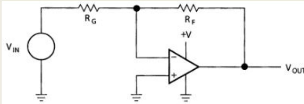
Рис. 3 – Схема включения ОУ с однополярным питанием
