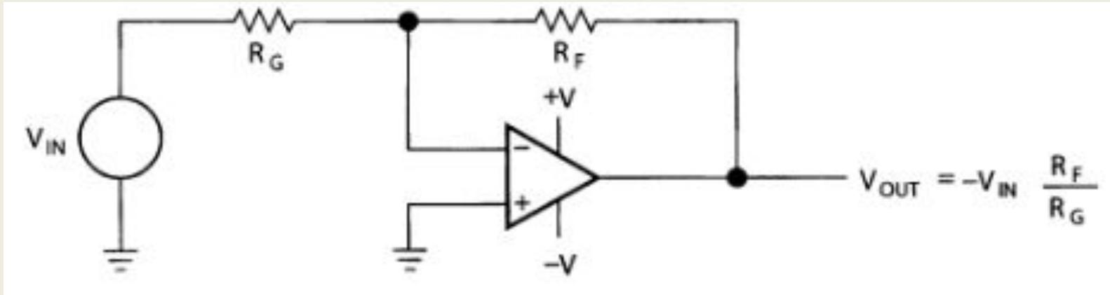
Рис. 1 – Схема включения ОУ с двухполярным питанием
