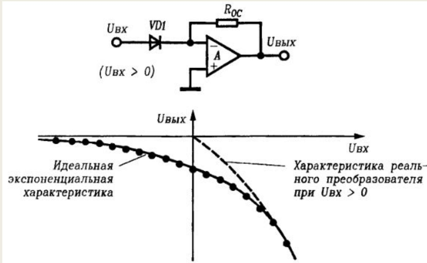
Рис. 7 – Основная схема экспоненциального преобразователя
