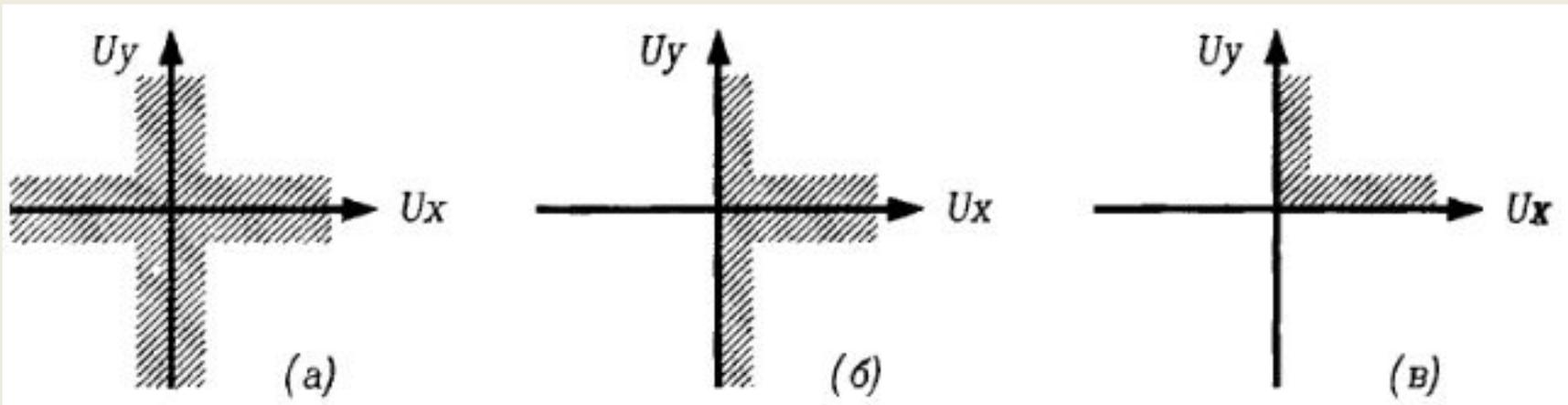
Рис. 9 – Полярности входных сигналов умножителя:
