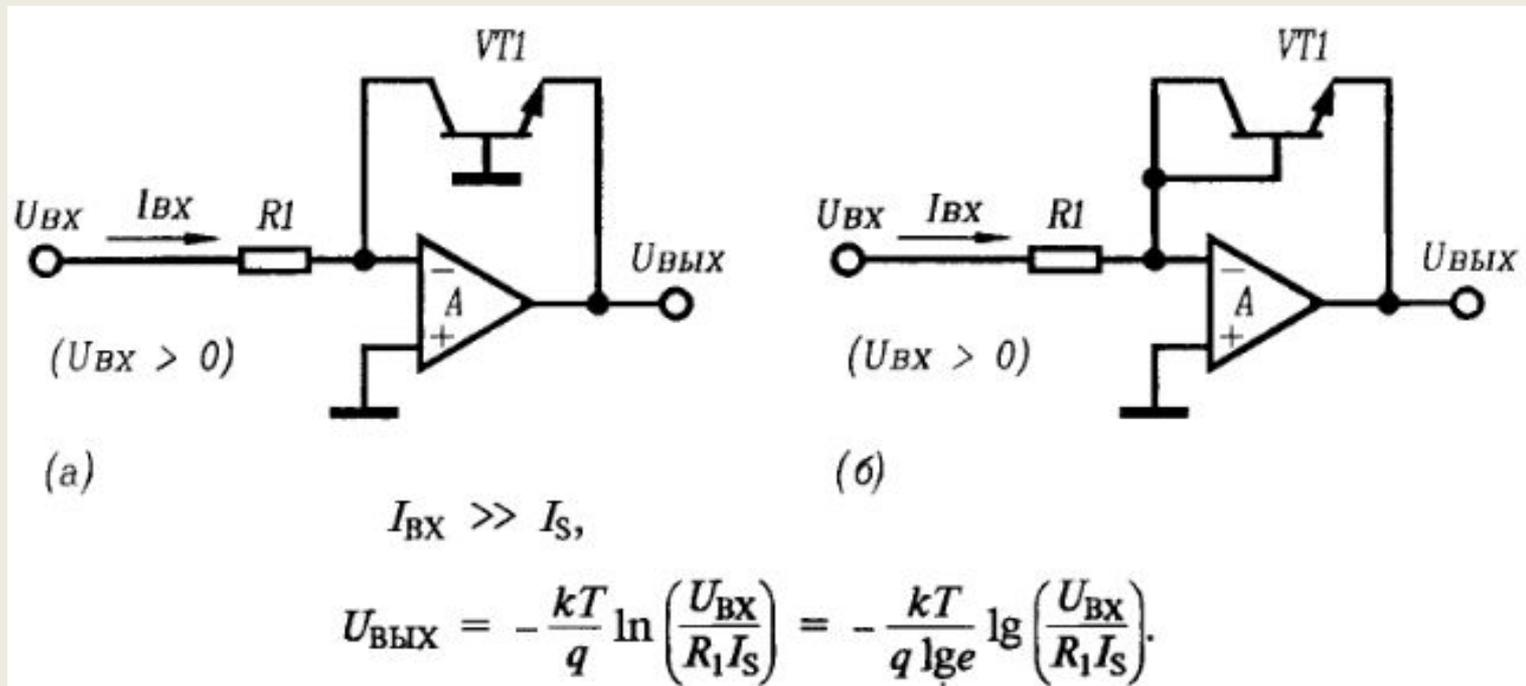
Рис. 6 – Схема логарифмического преобразователя на транзисторе
