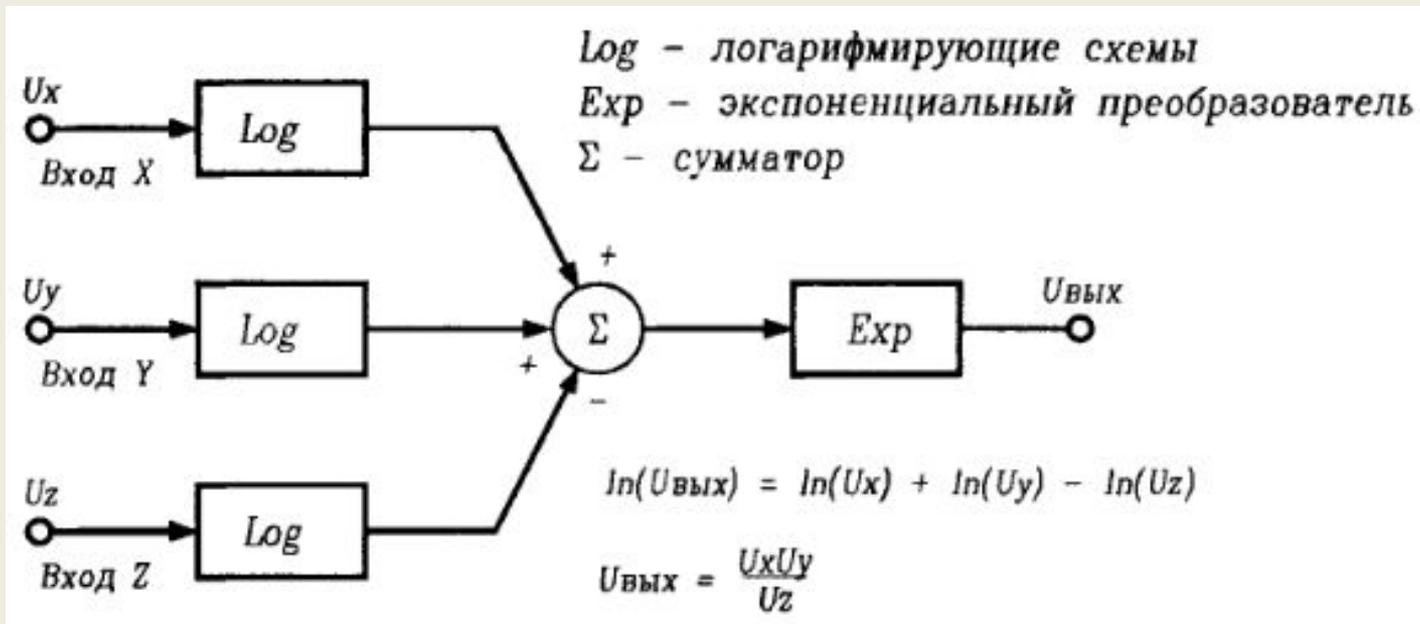
Рис. 11 – С логарифмированием и антилогарифмированием сигнала
