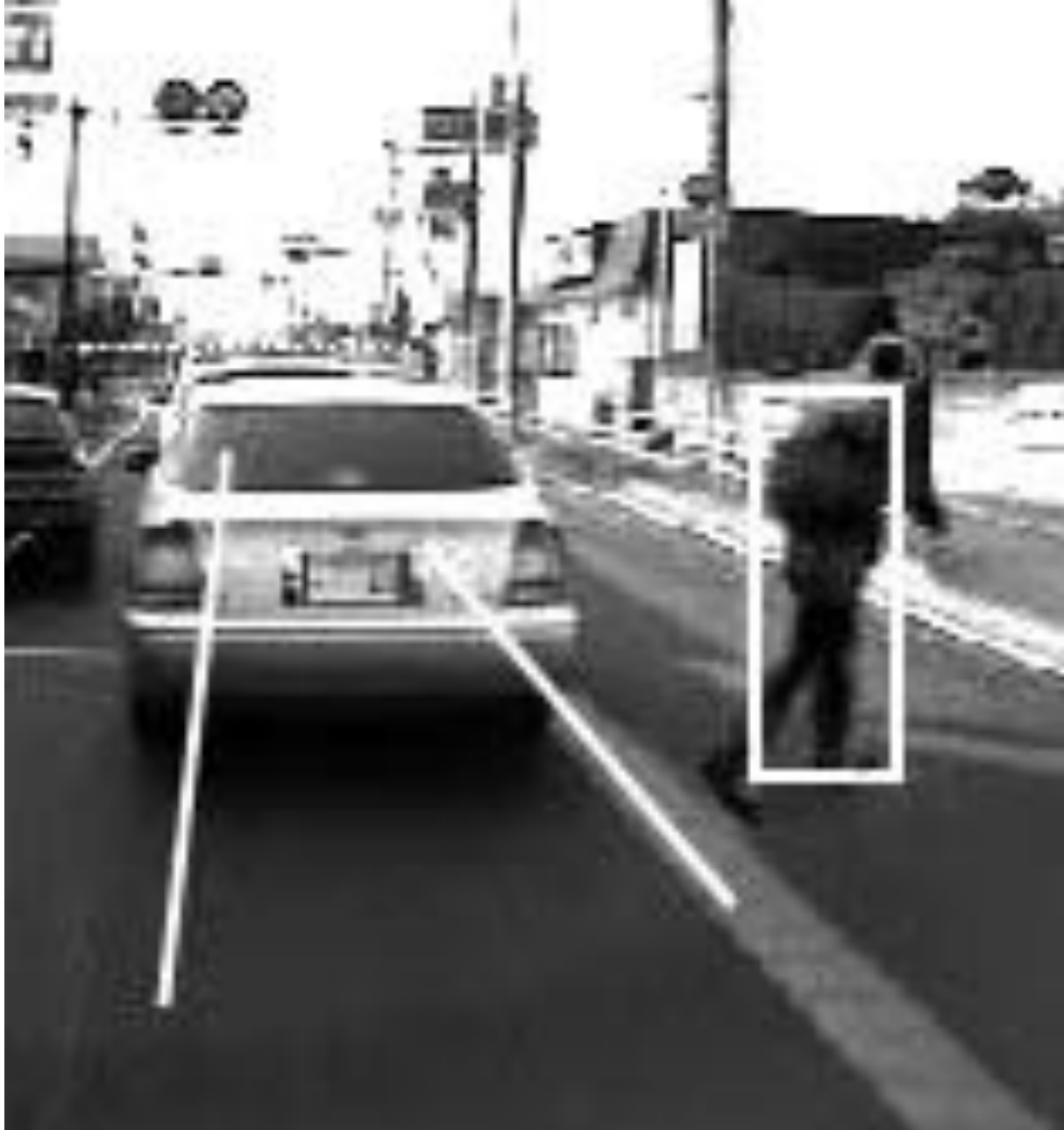
Система розпізнає пішохода, який перетинає дорогу перед автомобілем
