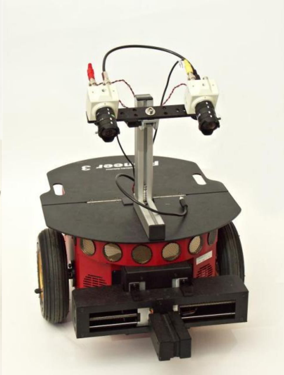
Багатофункціональні самоходні роботи з бортовим комп'ютером та лазерною моноскопічною (зліва) і стереоскопічною (справа) системами зору
