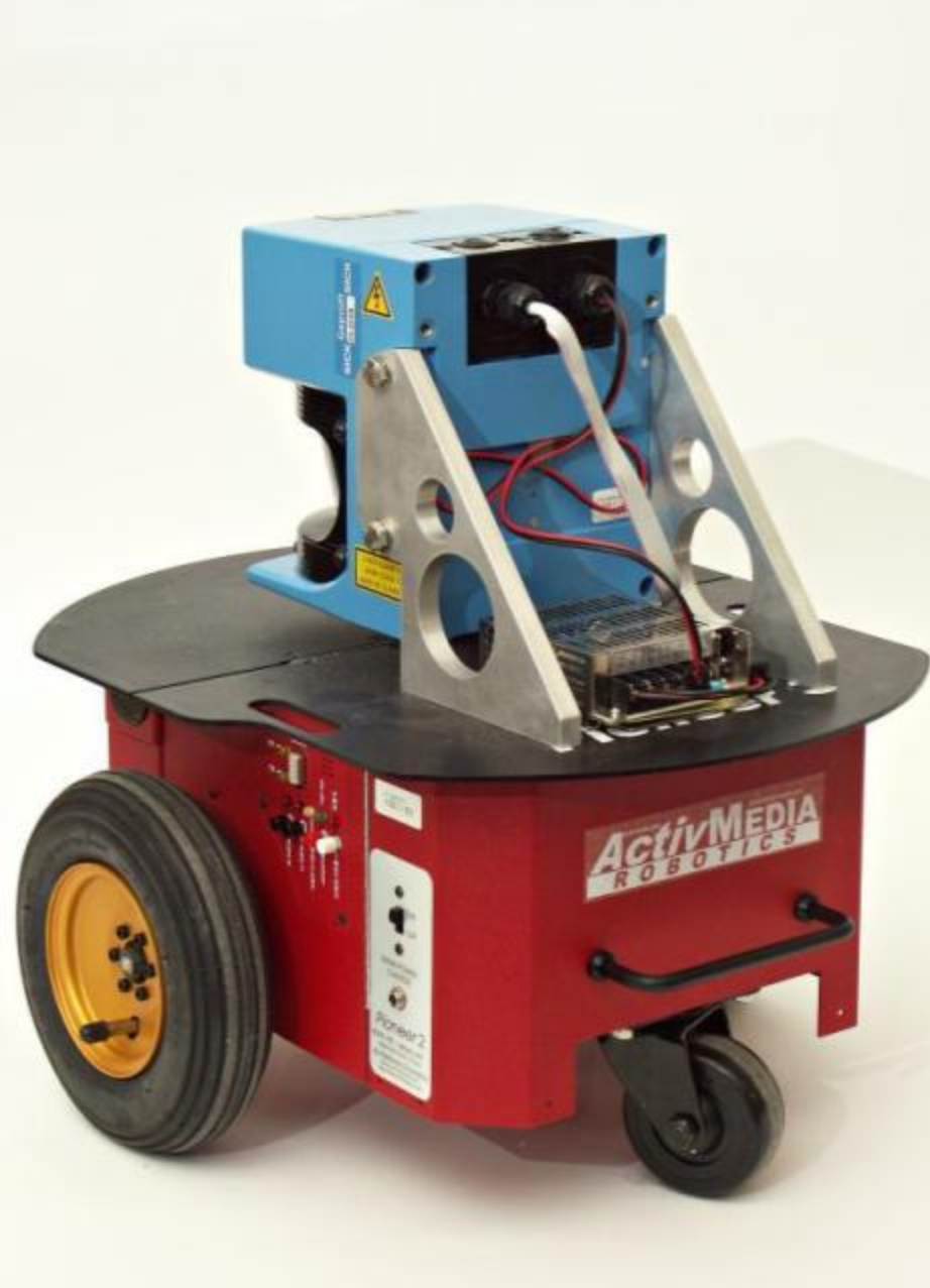
Багатофункціональні самоходні роботи з бортовим комп'ютером та лазерною моноскопічною (зліва) і стереоскопічною (справа) системами зору
