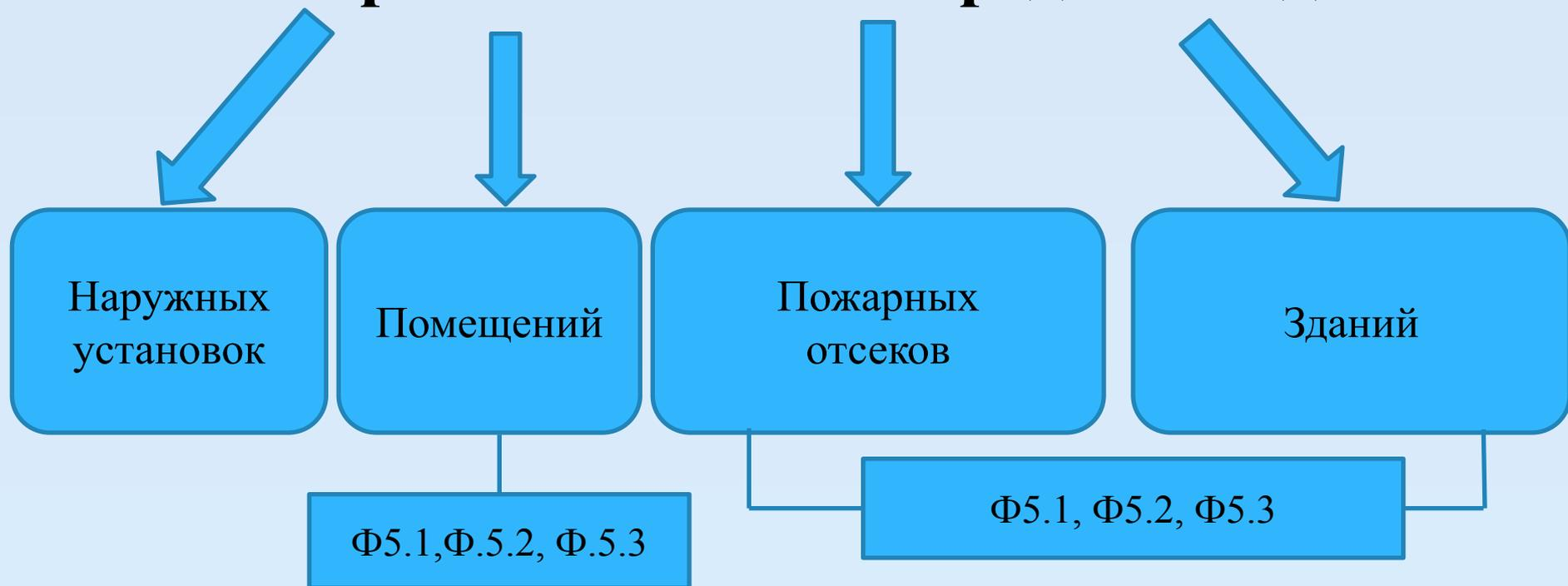
**5.3.10** Категорирование зданий классов **Ф5.1** – **Ф5.3**, а также производственных (в том числе лабораторий и мастерских) и складских помещений, **входящих в их состав**, по взрывопожарной и пожарной опасности осуществляется в соответствии с ТКП 474. (ТКП 45-2.02-315-2018)
