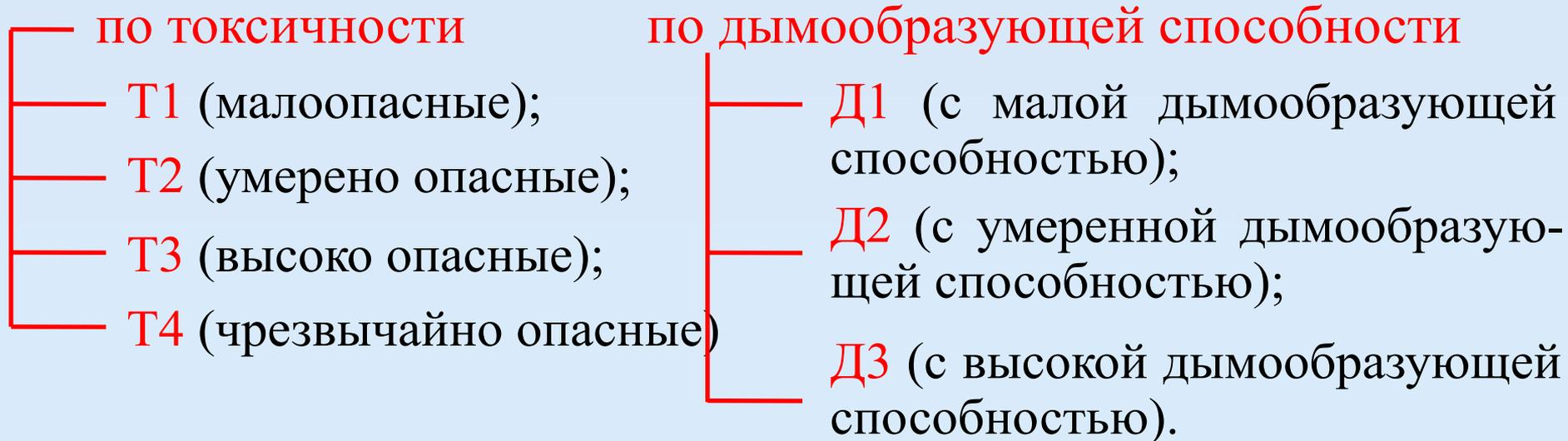
Группы строительных материалов по **токсичности** продуктов горения определяются в соответствии с **ГОСТ 12.1.044**. Показатель токсичности продуктов горения в соответствии с **ГОСТ 12.1.044** определяют для **полимерных и полимерминеральных** отделочных (облицовочных) и теплоизоляционных материалов.
