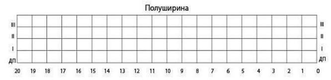
На проекции «БОК» строят батоксы по размерам, которые снимают с корпуса от основной плоскости (ОП) до точек пересечения искомого батокса со шпангоутами. Эти размеры откладывают от основной плоскости на соответствующих шпангоутах главного (бокового) вида. Полученные точки соединяют плавной кривой линией.
