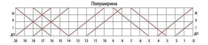
Одним из способов проверки правильности выполнения сетки теоретического чертежа является проверка при помощи диагоналей, которые должны проходить через точки пересечения теоретических линий.
