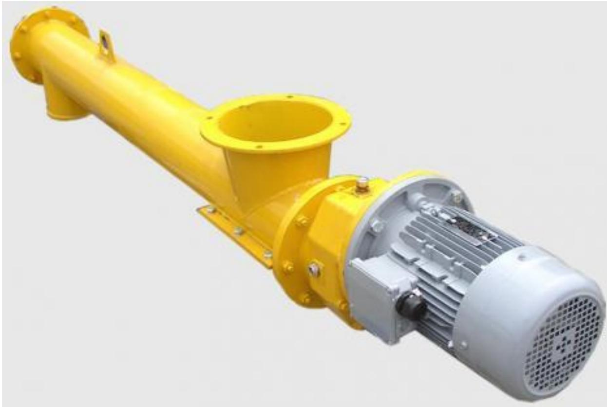
Конвейер используется для подачи сыпучих продуктов в весовые дозаторы, смесители и другие устройства. Производительность от 1 до 104 м<sup>3</sup>/ч. Мощность электродвигателя от 0,75 до 90 кВт.
