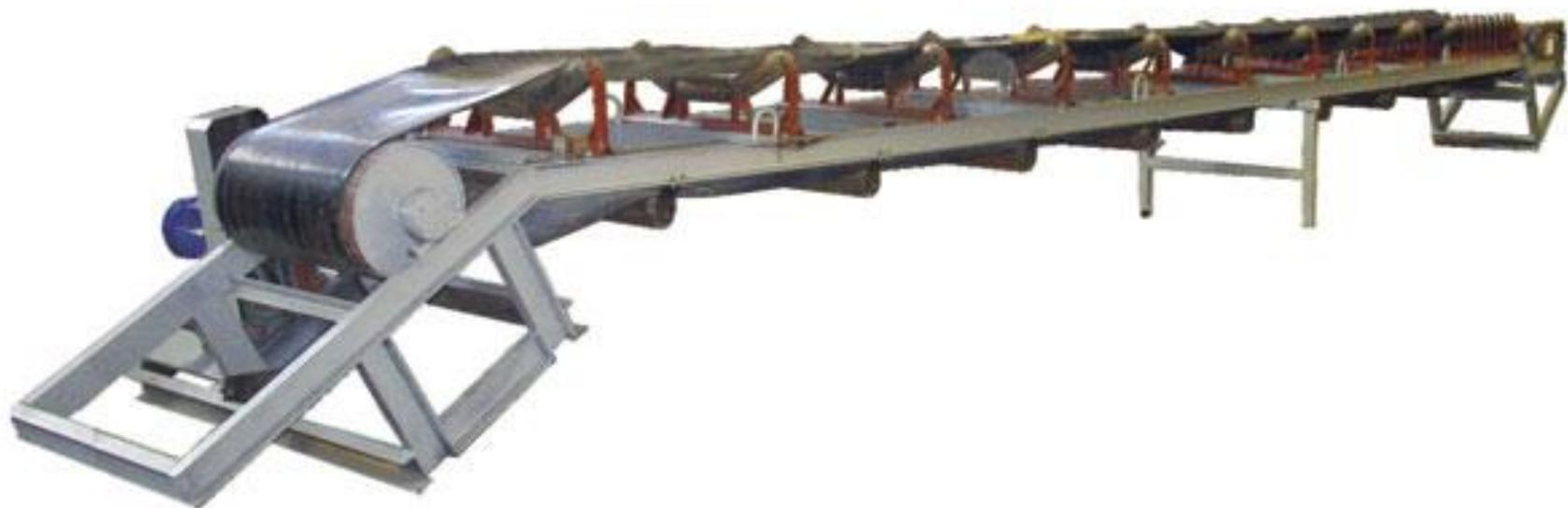
Предназначен для транспортировки сыпучих и кусковых материалов (песок, щебень). Производительность от 5 до 430 т/ч. Ширина ленты от 500 до 1400 мм. Скорость ленты от 0,5 до 3 м/с. Мощность двигателя от 3 до 75 кВт
