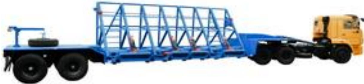
**Полуприцеп панелевоз кассетный 949621
