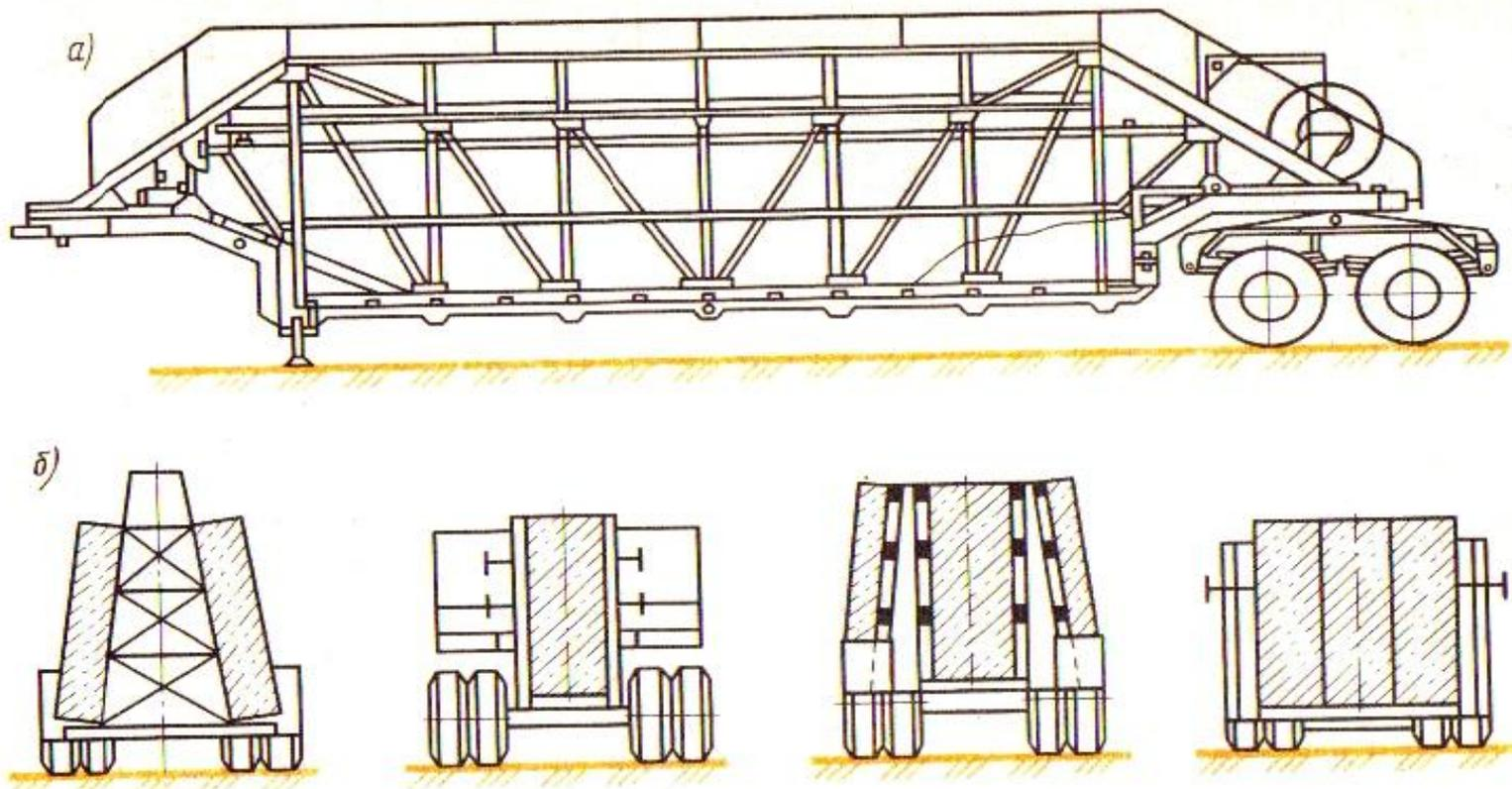
А) Общий вид полуприцепа хребтового типа
