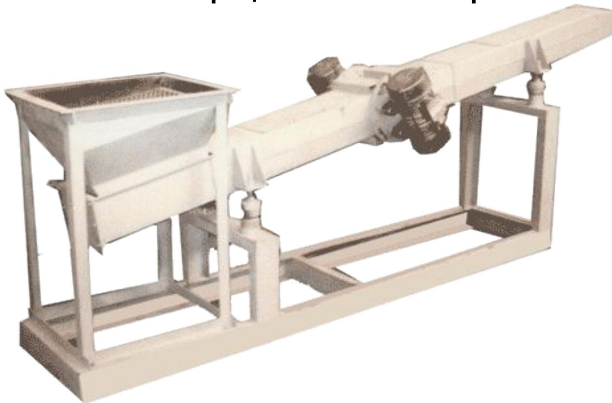
Вибрационный конвейер предназначен для перемещения груза путем воздействия направленных колебаний, возбуждаемых парой вибраторов. Производительность (песок) до 5 т/ч. Масса 400 кг. Потребляемая мощность  $2 \cdot 0,37$  кВт
