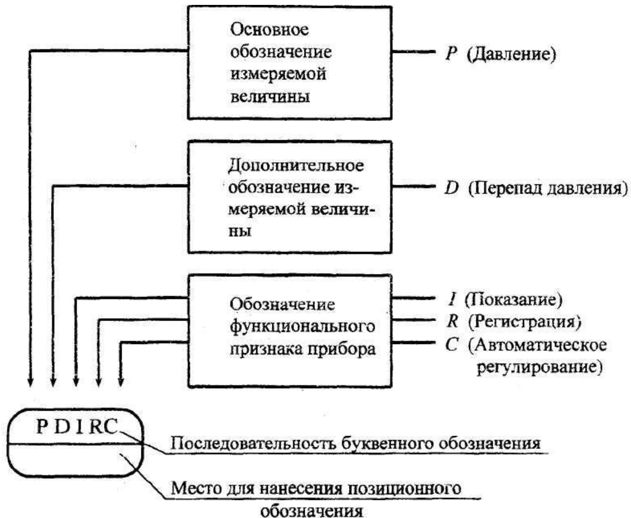
Рис.3. Принцип построения условного обозначения прибора
