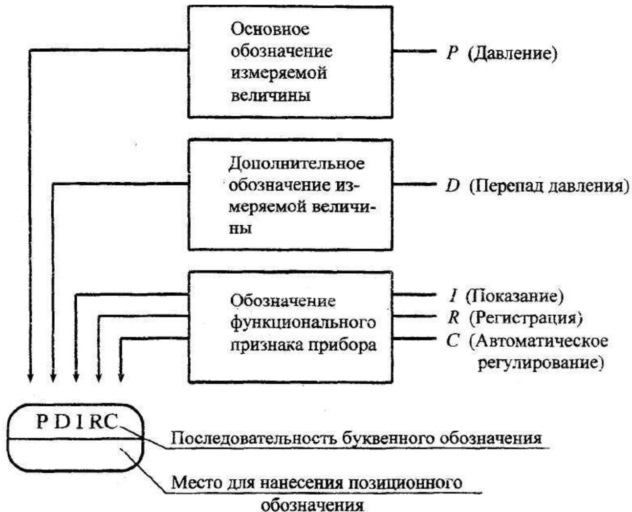
Рис.3. Принцип построения условного обозначения прибора
