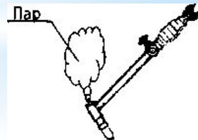
\* В процессе выполнения газопламенных работ вы должны следить, чтобы давление кислорода на входе в горелку (резак) было выше, чем давление горючего в бачке
