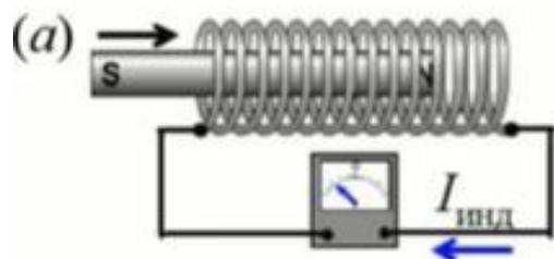
Генерируемая в контуре ЭДС пропорциональна скорости изменения магнитного потока
