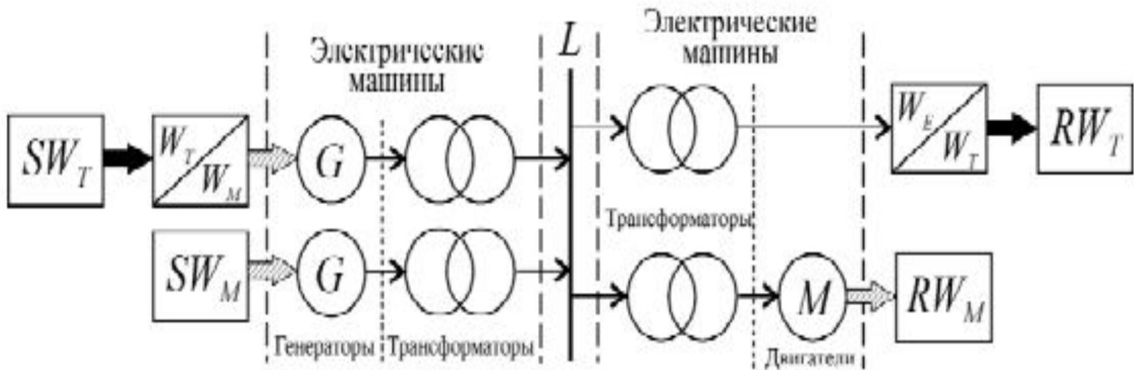
Структурная схема передачи тепловой и механической энергии от источников к приёмникам
