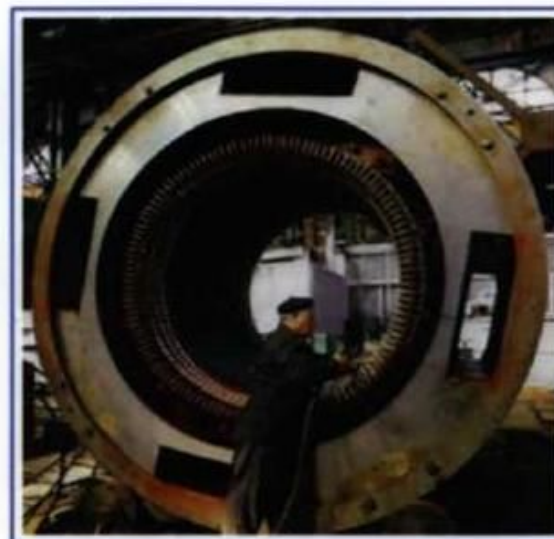
Обмотки электрических машин
